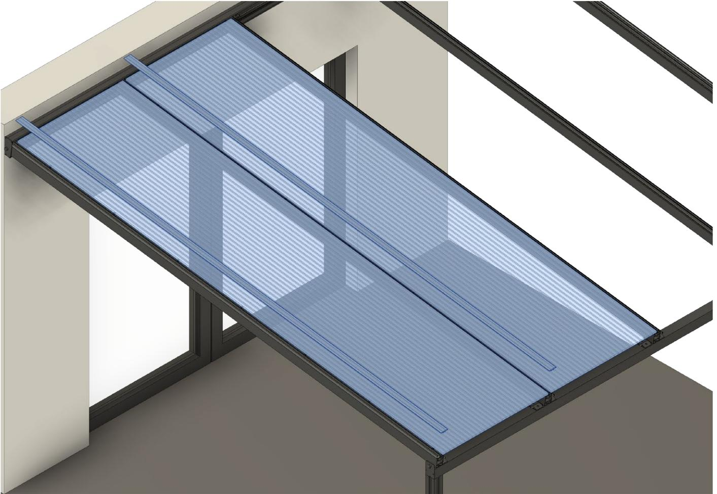
Legen Sie die erste Platte auf und richten Sie sie korrekt aus – beachten Sie auch hier die korrekte Ausrichtung der Schutzfolien. Profiloberteil alle 40 cm mittig vorbohren ( $\text{Ø}7$  mm), die erste Bohrung erfolgt nach 6cm. Anschließend auflegen und mit dem Unterteil verschrauben.
